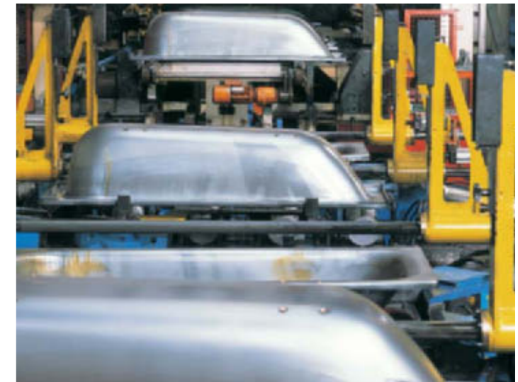
Eine hydraulische Ziehpresse formt die Stahlwanne nahtlos aus einem Stück.
