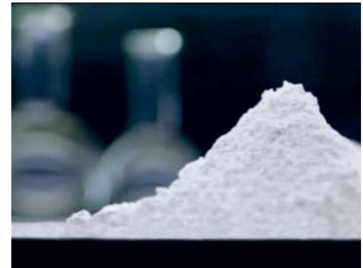
Aus Quarzsand, Feldspat und Soda wird Email-Pulver.
