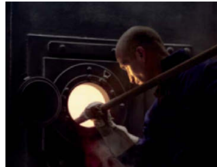
Nach dem Schmelzprozess entsteht die Email-Fritte.
